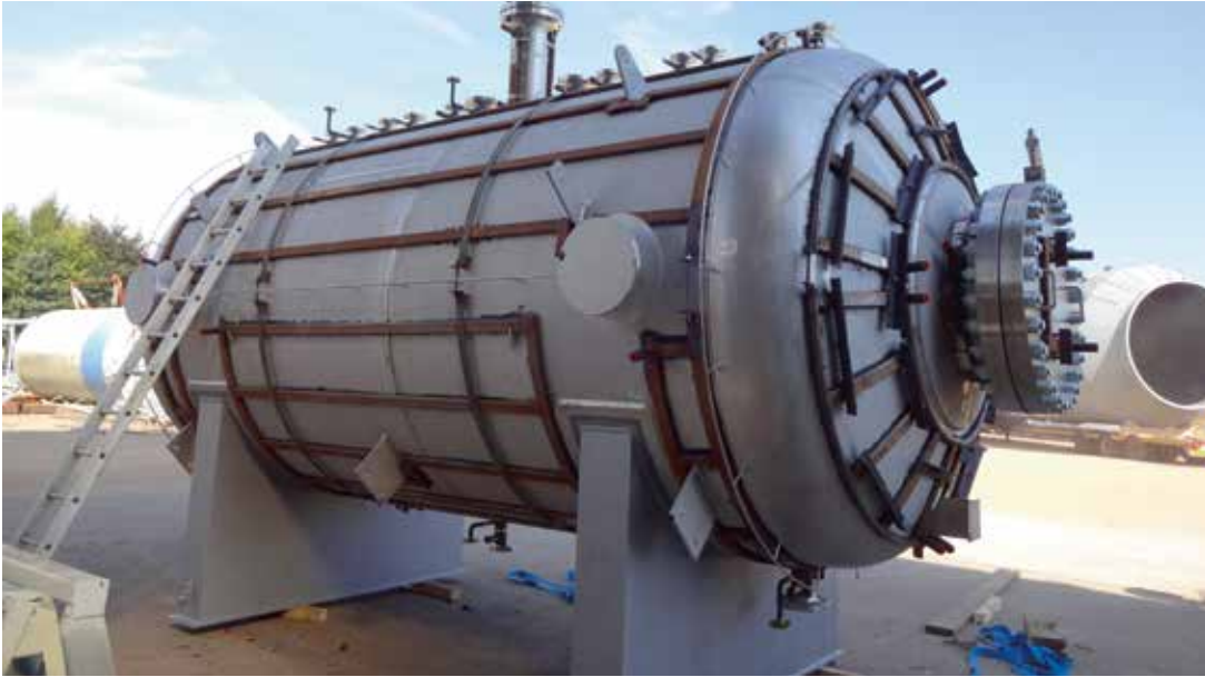
« Vermeer ThermEx heating elements on sulphur vessel.
